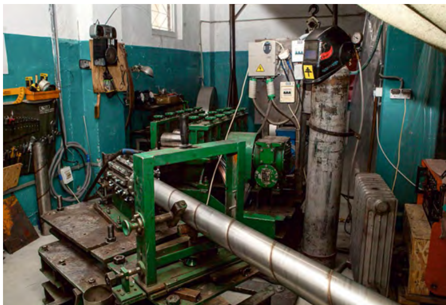
❖ Фото 2. Труbosварочный стан, спроектированный ООО «Теплообмен»
