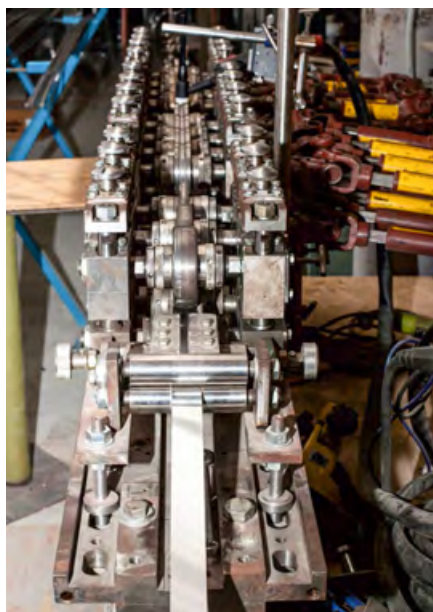
❖ Фото 1. Трубосварочный стан, спроектированный ООО «Теплообмен»
