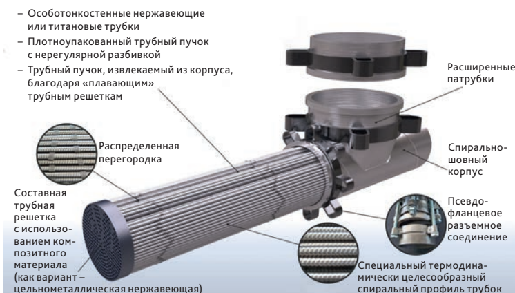
■ Рис. 2. Особенности теплообменниках ТТАИ (собственные разработки)
