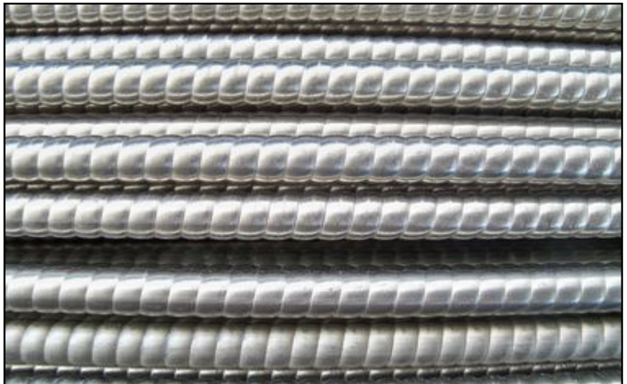
Рис. 3. Профилированные теплообменные поверхности ТТАИ, упакованные в трубный пучок.
